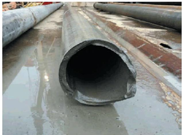
Рис. 4. Причина обрыва бурильных колонн по телу ЛБТ (легкосплавных бурильных труб)
