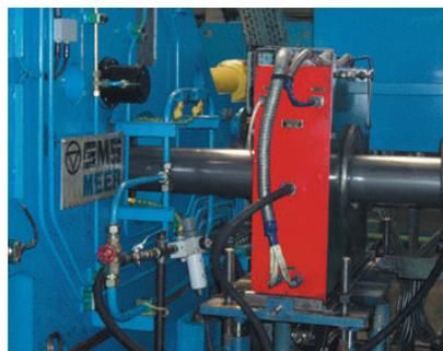
Вихретоковые дефектоскопы для контроля труб и сварного шва
