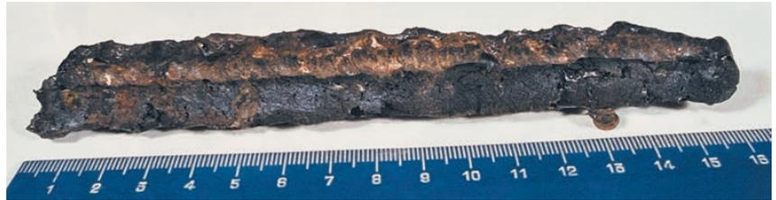
Рис. 6. Образец сварного шва со сплошным непроваром
