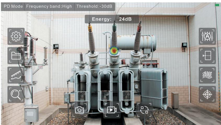
Рис. 4. Пример выявления ЧР на высоковольтном вводе
