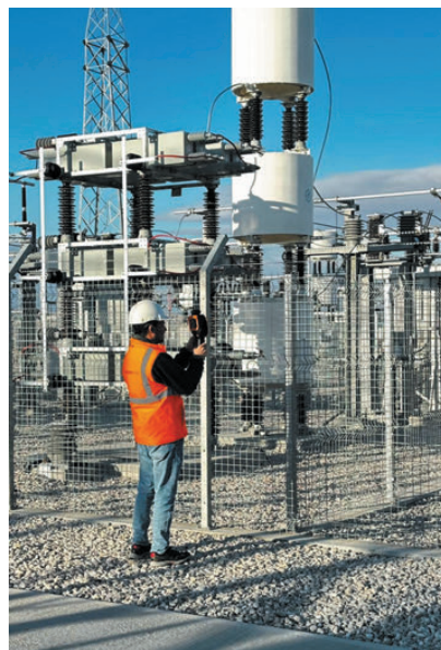
Рис. 6. Выполнение контроля энергообъектов на расстоянии с помощью визуально-акустических устройств HertZinno
