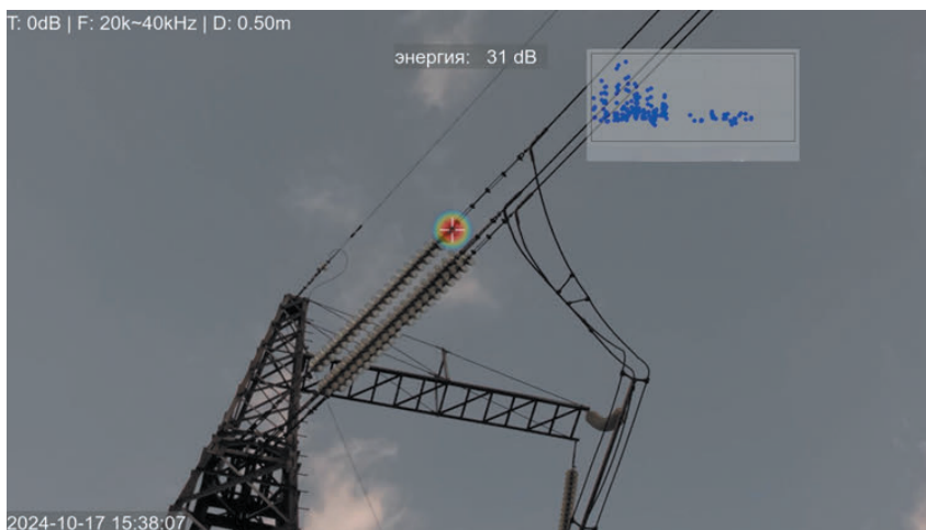
Рис. 5. Пример выявления ЧР с выводом PRPD-диаграммы при контроле ЛЭП
