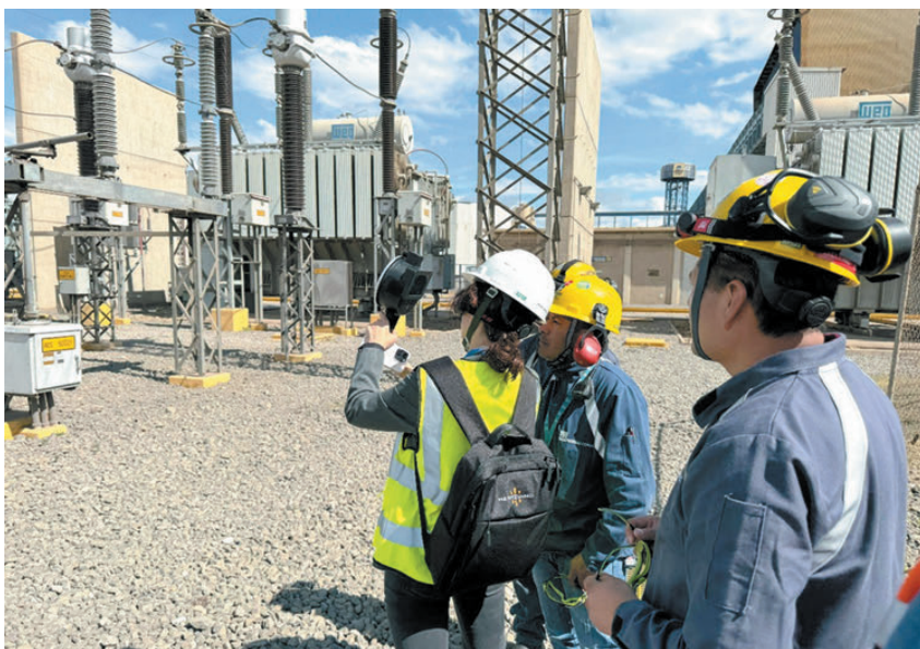
Рис. 6. Выполнение контроля энергообъектов на расстоянии с помощью визуально-акустических устройств HertZinno
