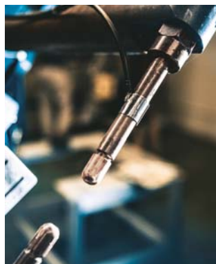
Система ультразвукового контроля точечной сварки в реальном времени RIWA
