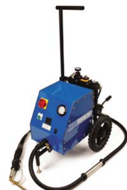
Двухструйное холодное напыление (Dual Flow Cold Spray — DFCS)
