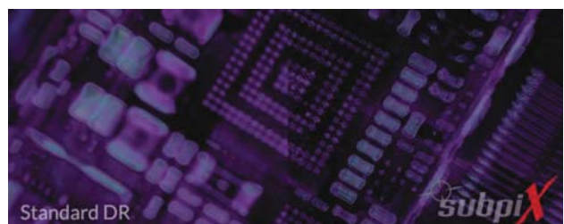
subpiX – технология улучшения резкости изображения за счет незначительных (в рамках отдельного пикселя) смещений детектора в момент регистрации изображения
