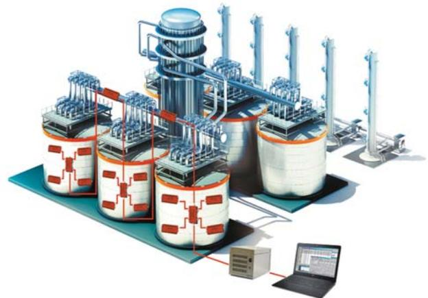
*Акустико-эмиссионный комплекс A-Line DDM-2 – второе поколение многоканальных модульных комплексов сбора и обработки АЭ-информации распределенного типа с последовательным высокоскоростным цифровым каналом передачи данных*
