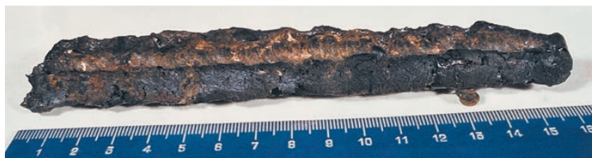
Рис. 6. Образец сварного шва со сплошным несплавлением
