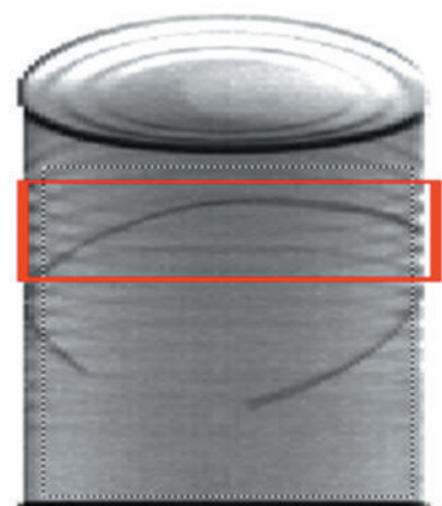
Рис. 10. Потемнения внутри металлизированных отверстий
