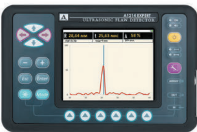
Пример финального задания по УК (конкурсантам необходимо было по А-скану, изменяющемуся при перемещении ПЭП, определить тип дефекта сварного соединения)
