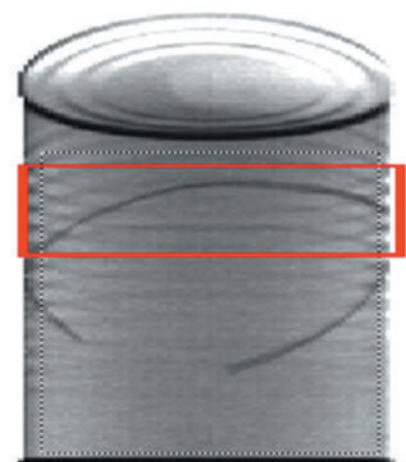
Рис. 10. Потемнения внутри металлизированных отверстий
