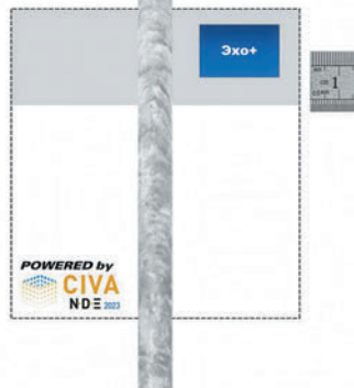
Пример финального задания по УК (конкурсантам необходимо было по А-скану, изменяющемуся при перемещении ПЭП, определить тип дефекта сварного соединения)
