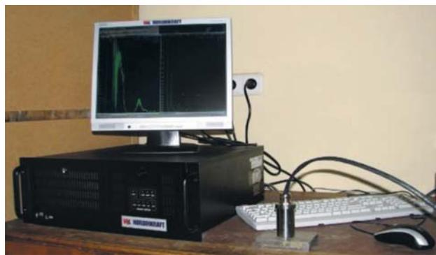
Рис. 22. Лабораторный макет толщиномера с ЭМАП
