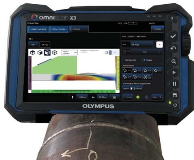
*Рис. 1. Дефектоскоп OmniScan X3 в режиме моделирования карты акустического воздействия AIM*
