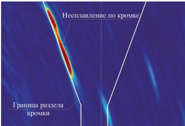
Рис. 2. Несплавление по кромке, выявленное методом TFM
