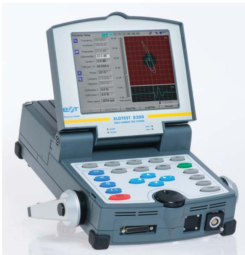
Рис. 1. Вихретоковый дефектоскоп ELOTTEST B320
