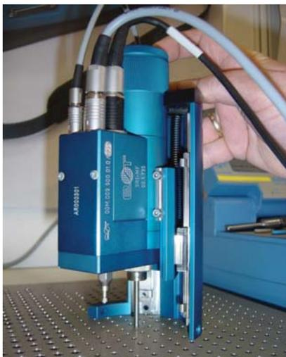
Рис. 2. Двухкоординатный ротор
