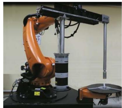
Роботизированный радиографический комплекс
