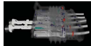
Автоматический поиск и группировка по размеру скрытых дефектов в материале
