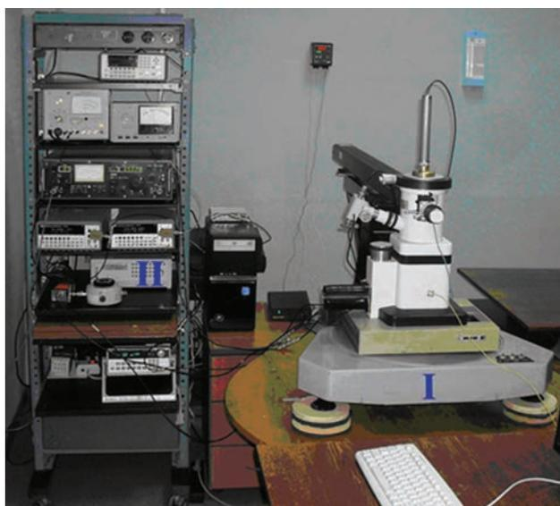
Государственный первичный эталон (ГЭП) единиц амплитуды ультразвукового смещения и колебательной скорости поверхности твердых тел: диапазон частот 0,3–3 МГц; диапазон амплитуд смещений  $5 \cdot 10^{-11}$ – $5 \cdot 10^{-10}$  м; диапазон колебательных скоростей  $2 \cdot 10^{-4}$ – $1 \cdot 10^{-3}$  м/с; суммарная стандартная относительная неопределенность результатов измерений ГЭП не превышает  $0,6 \cdot 10^{-2}$  (ГОСТ Р 8.826–2013)
