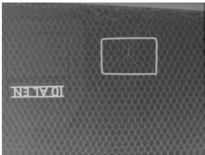
Рис. 8. Цифровое изображение фрагмента сотовой конструкции закрылка самолета с локализацией дефектного участка для подробного исследования с помощью детектора S10811-11
