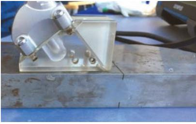
Рис. 11. Экспериментальная настройка для вертикальных дефектов
