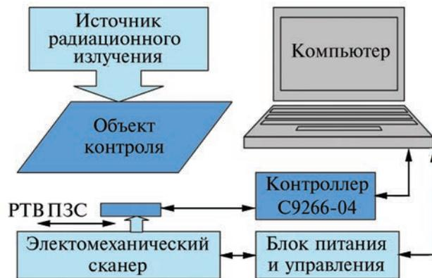
Рис. 6. Структурная схема портативной цифровой рентгентелевизионной системы, способной с помощью миниатюрного преобразователя и механического сканера контролировать объекты большой протяженности
