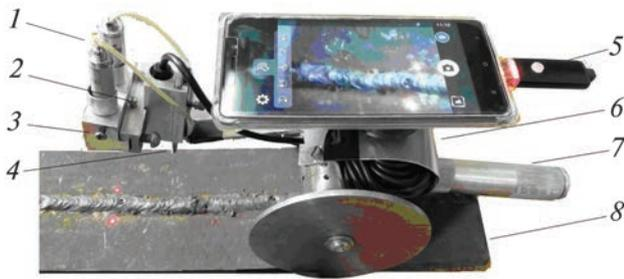
Рис. 1. Оптоэлектронный прибор ВИК/ТВА-1 для визуального контроля на базе подвижного намагничивающего устройства:
