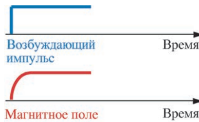
Рис. 2. Фаза излучения магнитного поля
