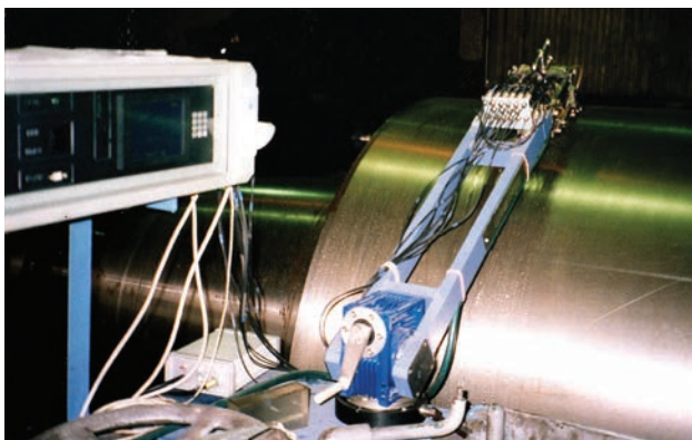
Установка «ВАЛОК» для контроля валков холодной прокатки на ПО «СЕВЕРСТАЛЬ», г. Череповец
