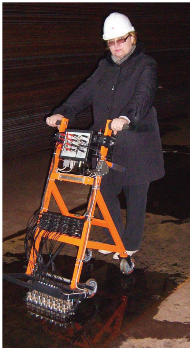
Мобильная 16-канальная установка «ЛИСТ-4» для контроля листового проката
