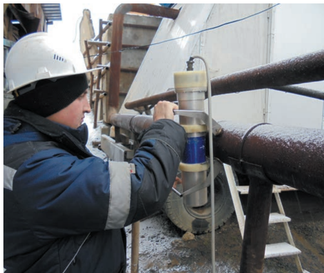
Магнитное устройство крепления на трубу позволяет устанавливать моноблок на трубу диаметром от 108 мм
