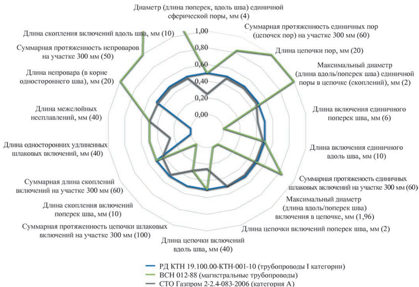
Рис. 2. Нормы отбраковки сварных соединений (по конкретным критериям) толщиной 10,0 мм в соответствии с требованиями различных нормативно-технических документов (в скобках приведен масштабный фактор)
