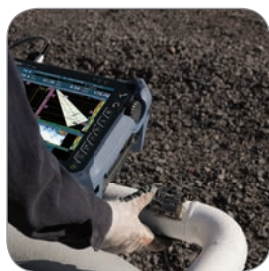
Контроль сварных швов труб малого диаметра
