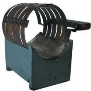
Рис. 4. Большой приставной соленоид диаметром 220 мм для стационарных магнитопорошковых дефектоскопов
