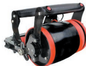
Рис. 6. РП для получения карты коррозии Рис. 7. РП низкой частоты
