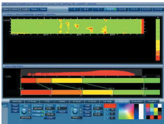
Рис. 14. С-скан и настройка новой карты цветов для определения степени пористости
