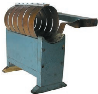
Рис. 3. Малый приставной соленоид диаметром 110 мм для стационарных магнитопорошковых дефектоскопов
