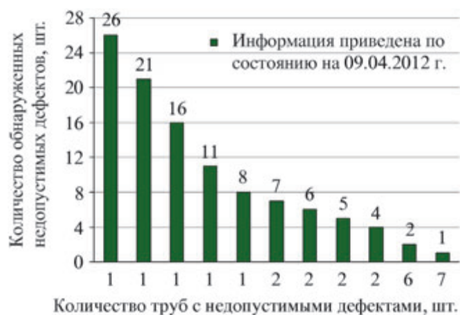
Рис. 15. Распределение недопустимых дефектов, шт./трубопровод (145 шт. на 9 апреля 2012 г.)
