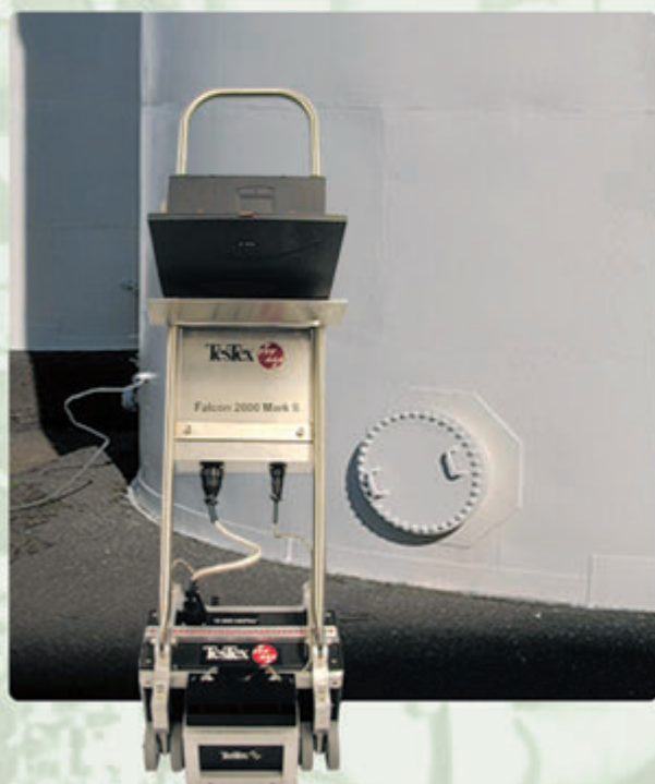
Система Falcon 2000 Mark II для контроля днищ резервуаров
