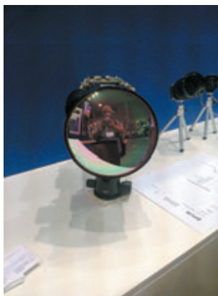
Стенд компании FLIR, панорамный тепловизор (слева), тепловизионные модули (справа)
