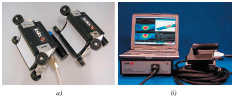
Рис. 5. Система PS-2000: а — сканеры TesTex; б — система PS-2000 в сборе
