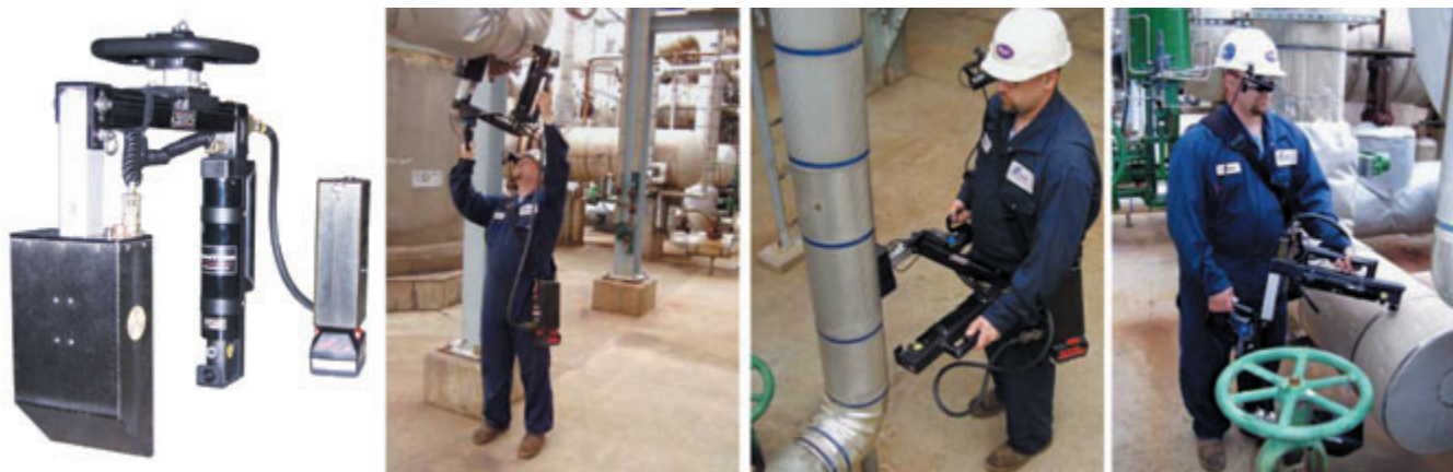
Рис. 17. Портативная флэш-радиография системы OpenVision LT-NTD
