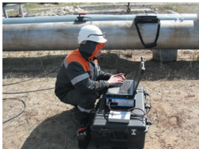
Рис. 3. Электромагнитная система PS-2000. Комплект включает в себя сканер, с помощью которого сканируют поверхность трубопровода, электронный блок и ноутбук
