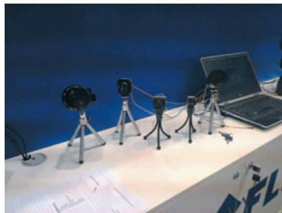
Стенд компании FLIR, панорамный тепловизор (слева), тепловизионные модули (справа)
