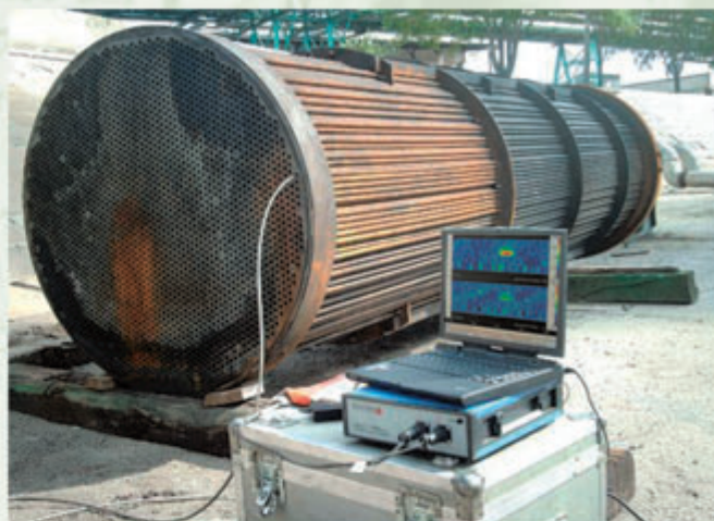
Система Eagle-2000 для внутритрубного контроля
