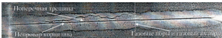
Рис. 5. Сварной шов: пористость, трещины и непровар
