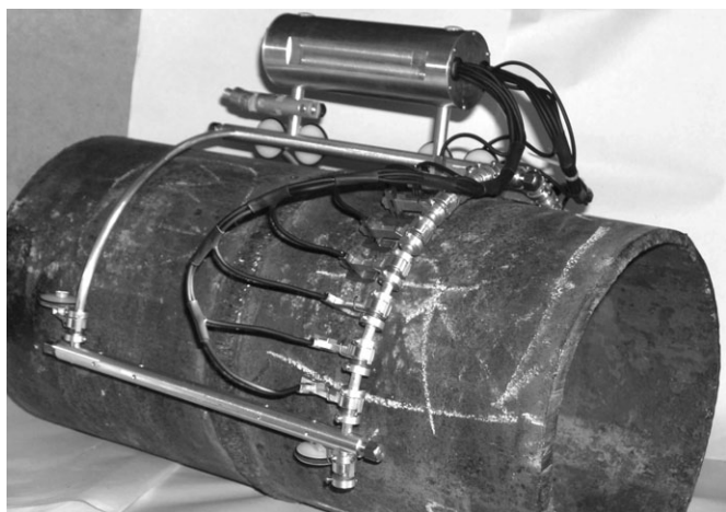
Рис. 2. Общий вид СУ для контроля труб Ø 200–1420 мм
