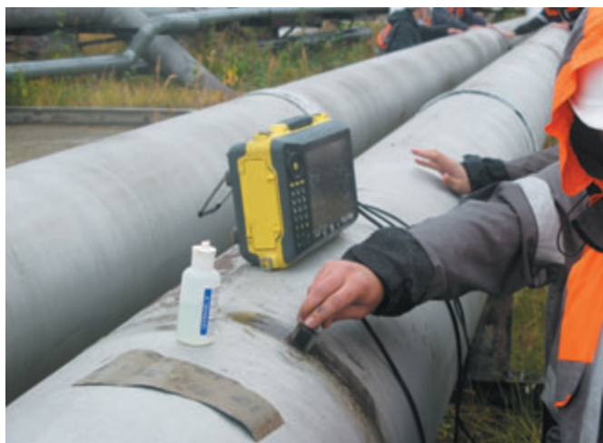
Рис. 8. Уточнение результатов с использованием HANFANG VEO фирмы SONATEST
