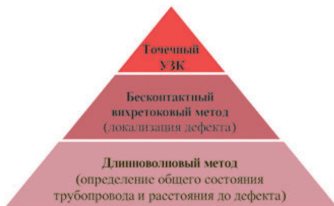
Рис. 1. Алгоритм обнаружения дефектов на трубопроводе
