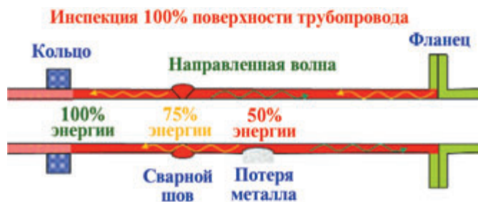
Рис. 4. Принципиальная схема работы длинноволнового метода
