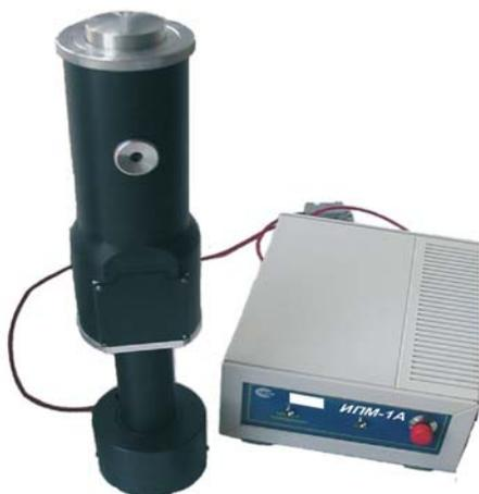
Рис. 9. Прибор для определения физико-механических свойств строительных материалов ИПМ-1А
