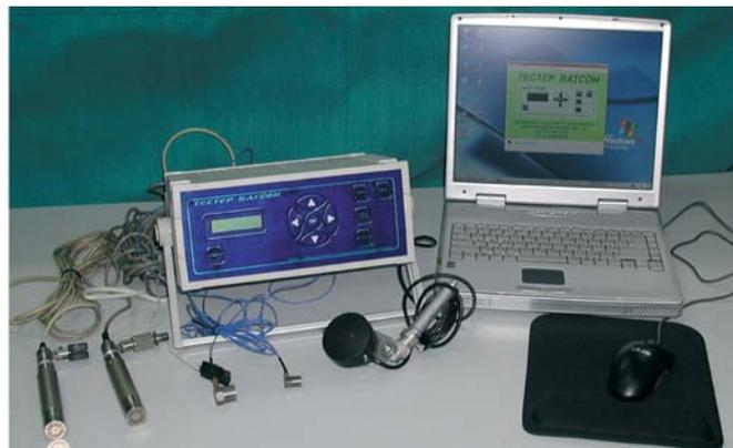
Рис. 11. Комплекс вибродиагностики и мониторинга технического состояния механических приводов
