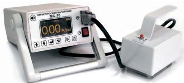
Рис. 5. Магнитный структуроскоп МС-10
