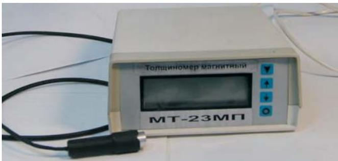
Рис. 6. Магнитный толщиномер покрытий МТ-23МП
