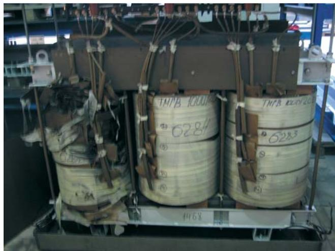
Рис. 5. Поврежденный трансформатор с дефектами обмотки и изоляции
