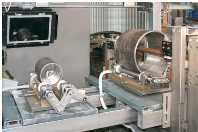
Рис. 1. УМПК-4м. Позиция намагничивания, позиция контроля
