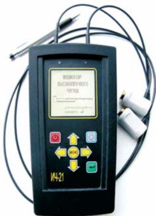
Рис. 2. Индикатор высокопрочного чугуна ИЧ-21
