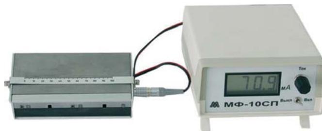
Рис. 1. Внешний вид прибора для проверки качества магнитных порошков и суспензий МФ-10СП
