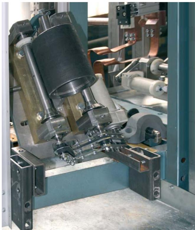
Рис. 2. УМПК-4м. Пост полива, опрокидывание муфты
