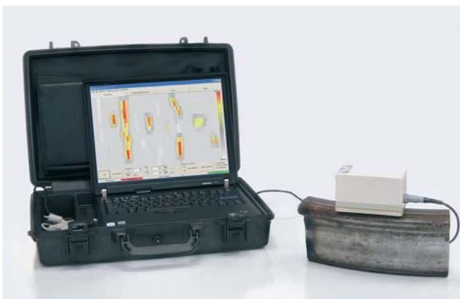
Рис. 7. Многоканальный вихретоковый дефектоскоп ВД-91НМ и портативный ПК
