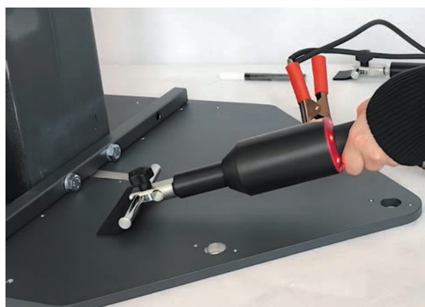
Рис. 1. Схема процесса электроискрового контроля (а) и фотография процесса выявления сквозного дефекта лакокрасочного покрытия при помощи электроискрового дефектоскопа «Корона» (б):
