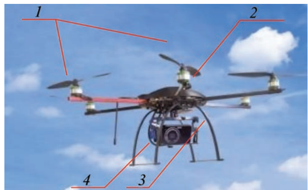
Рис. 5. Типовая конструкция БПЛА вертолетного типа многороторной схемы: 1 – несущие винты; 2 – центральный двигатель; 3 – нагрузка; 4 – шасси
