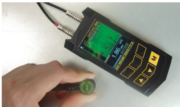
Портативный multifunctional ультразвуковой толщиномер «Булат 3»
