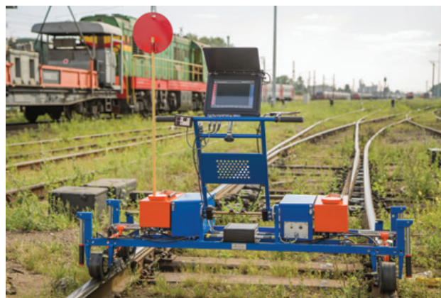
Рис. 2. Дефектоскопная тележка «АВИКОН-31» с расширенными функциональными возможностями контроля рельсов
