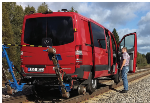
Рис. 3. Автомобиль-дефектоскоп с комплексом «АВИКОН-31» для контроля рельсов с регистрацией сигналов и видеоконтролем на скорости до 30 км/ч
