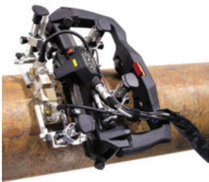
Новый сканер AxSEAM Olympus, не требующий сложной настройки, позволяет оператору самостоятельно быстро и эффективно выполнить контроль продольных сварных швов трубопроводов в полевых условиях. Наряду с дефектоскопом OmniScan™ X3 сканер является одним из эффективных решений ультразвукового контроля с применением фазированных решеток и предназначен для контроля продольных сварных соединений труб и резервуаров высокого давления.
