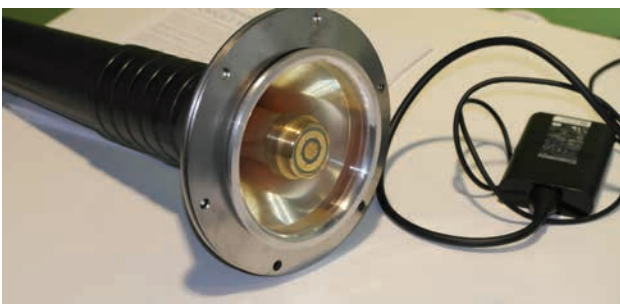
Демонстрационный образец необслуживаемого разъема высоковольтного кабеля
