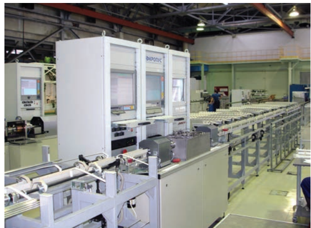
Рис. 2. Установка контроля УСКТ-8 с вращательно-поступательной подачей трубы через иммерсионную ванну. АО «Элемаш»
