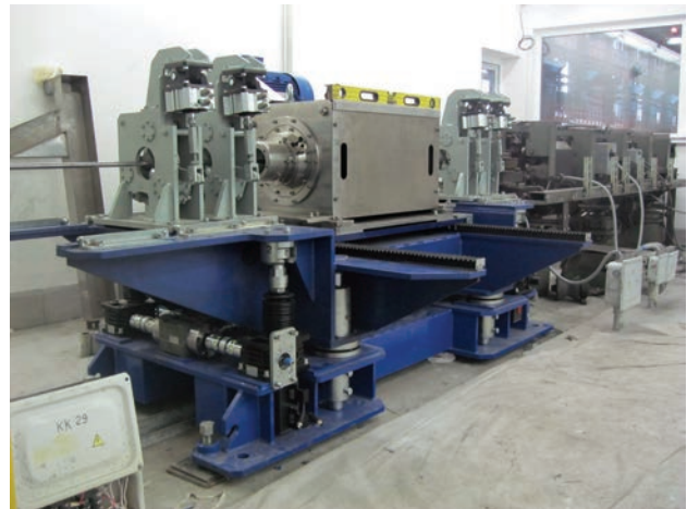
Рис. 1. Установка ротационного типа УКВ-90, обеспечивающая вращение ротора вокруг трубы со скоростью 3000 об/мин. АО «Синарский трубный завод»
