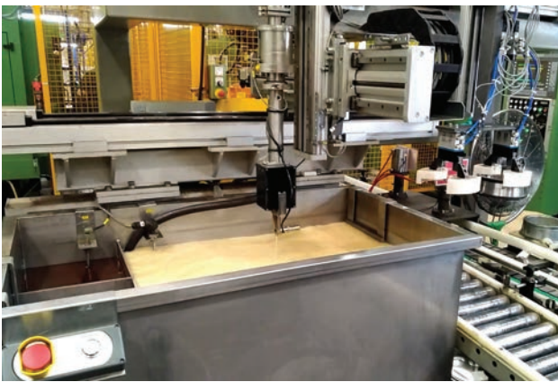
Рис. 5. Установка контроля колец АУКП-250 на ООО «ЕПК-Бренко»
