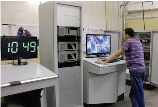
Рис. 6. Системы АСНК-Композит для бесконтактного контроля композитных изделий, позволяющие организовать удаленный многопараметровый контроль из пультовой оператор
