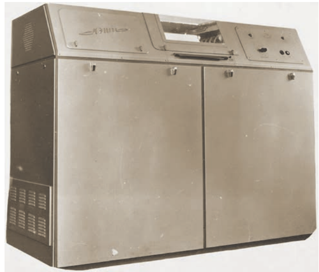
Рис. 11. Шкаф с электронной аппаратурой установки типа УЗУЛ-01
