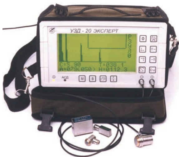
Рис. 14. Один из первых отечественных портативных ультразвуковых дефектоскопов с матричным экраном типа УЗД-20
