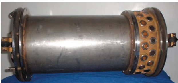
Рис. 15. Неавтономный ультразвуковой дефектоскоп-снаряд для контроля труб систем коммунального водоснабжения
