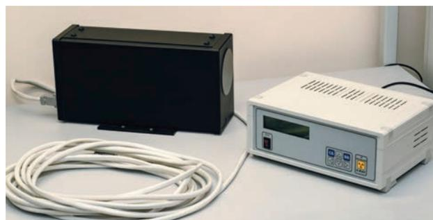
Рис. 3. Микрофокусный рентгеновский аппарат РАП-200М
