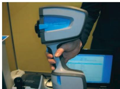
Портативный спектрометр 4300 Handheld FTIR (MILLAB)
