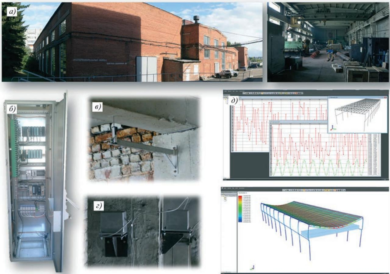
Рис. 3. Система структурного мониторинга строительных конструкций: а – объект мониторинга – одноэтажное промышленное здание; б – контрольно-измерительное оборудование; в – датчик перемещений; г – сейсмодатчики; д – ПО MStruct
