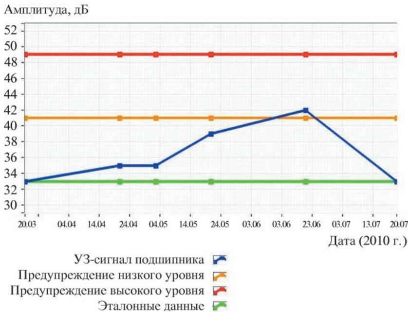
Рис. 4. Хронология смазки приводного подшипника
