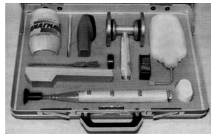
Рис. 1. Комплект технических средств для МПК с намагничивающим устройством для разнонаправленного локального намагничивания протяженных объектов
