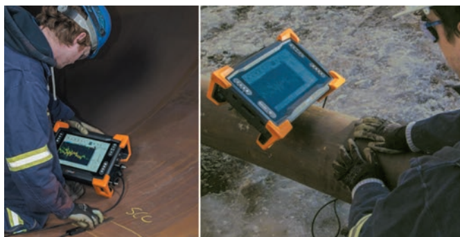
Рис. 3. Поиск зон КРН на трубопроводах различного диаметра
