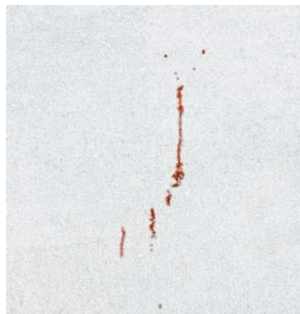
Рис. 2. Результаты капиллярного контроля
