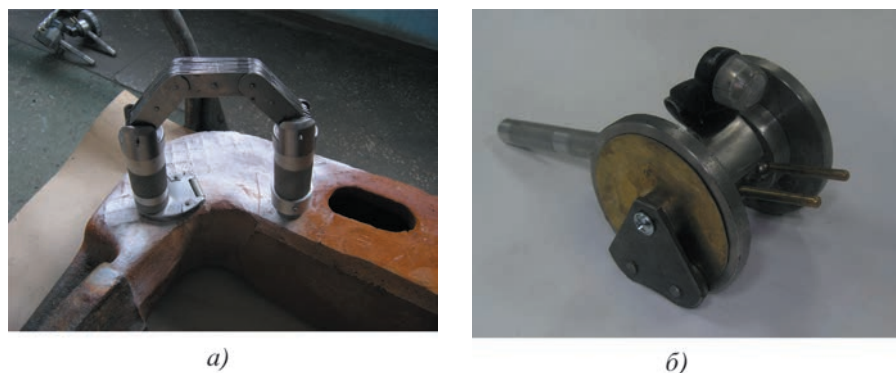
Рис. 6. Устройства ТВА для контроля изделий с определенной кривизной поверхности: а – ТВА-5 с подвижным полюсом, перемещаемым в зоне расположения неподвижного полюса; б – ТВА-9, имеющее на каждом полюсе три точки контакта с контролируемым изделием
