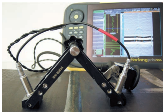
Рис. 3. Прибор Harfang Prisma UT и комплект преобразователей для TOFD
