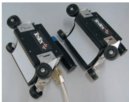
Рис. 2. Многоканальные сканеры для обследования трубопроводов с внешней стороны
