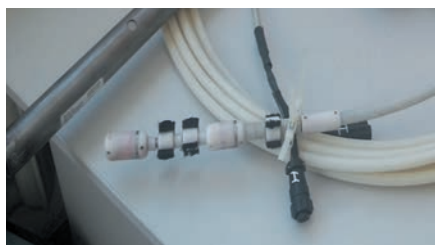
Рис. 3. Преобразователь для контроля трубных пучков теплообменников
