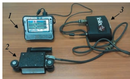
Рис. 1. Состав системы TiS 8C: 1 – промышленный мини-компьютер; 2 – сканер; 3 – электронный блок
