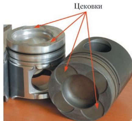
Рис. 4. Цековки под клапана
