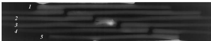
Рис. 2. Рентгенограмма пяти образцов паяных соединений статорных обмоток электродвигателя
