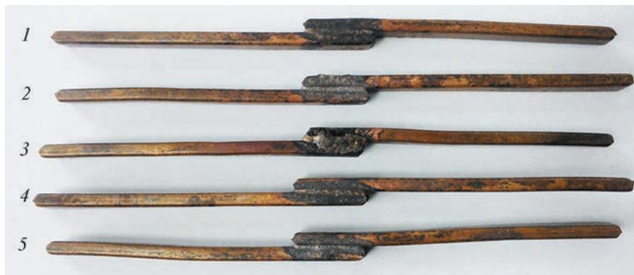
Рис. 1. Общий вид паяных соединений статорных обмоток электродвигателя
