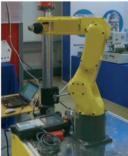
Лазерный измерительный робот, «Нева Технолоджи»
