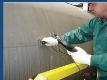
Специализированные приборы и высокочувствительные датчики для бесконтактной магнитометрической диагностики теплопроводов, газопроводов и других трубопроводов, расположенных под слоем грунта, в труднодоступных каналах с целью определения участков, предрасположенных к повреждениям
