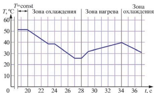
Рис. 3. Характер изменения максимальной температуры контрольного образца в процессе термографической съемки
