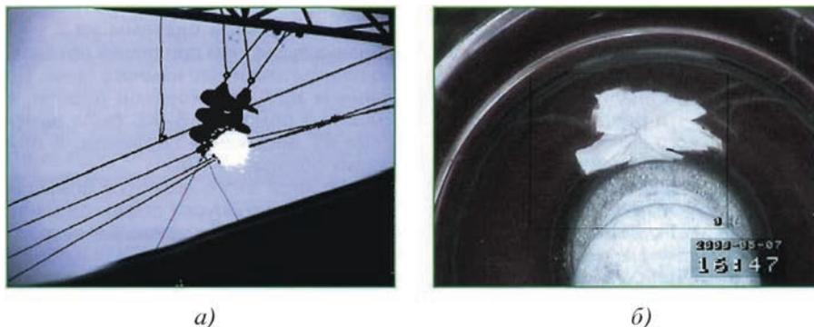
Рис. 6. Дефектная гирлянда из трех фарфоровых изоляторов типа ПФ-70: а – двухспектральное (УФ + видео) изображение гирлянды; б – внешний вид дефекта нижнего изолятора (скол фарфора в районе стержня)
