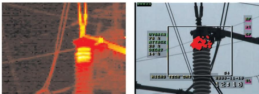
Рис. 2. Дефект изоляторов, выявленный тепловизором и подтвержденный результатами контроля в ультрафиолетовом спектре излучения
