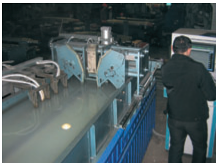
Рис. 1. Система автоматизированного ультразвукового контроля осей САУЗК «Унискан-ЛуЧ ОСЬ-4»
