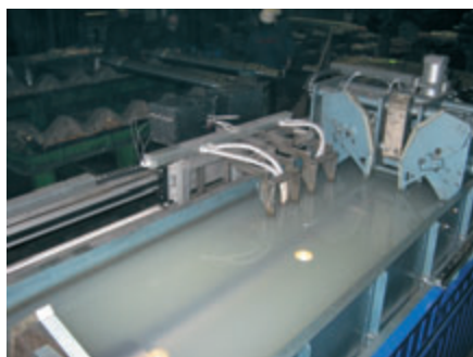
Рис. 8. Проведение контроля полуобработанной оси на ЧАО «ЛУГЦЕНТРОКУЗ им. С.С. Монастырского»
