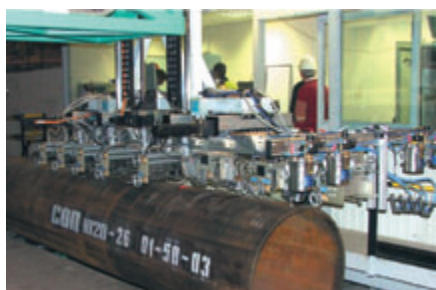
Наладка установки НК-360 на стане по производству сварных труб ВМЗ
