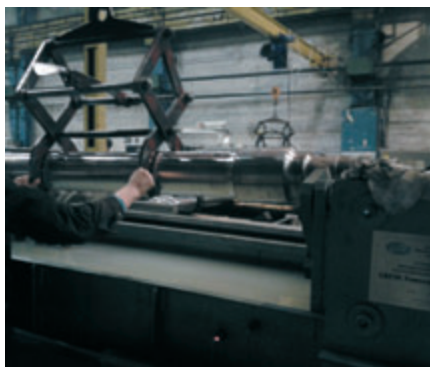
Рис. 3. Загрузка контролируемой оси на пост контроля
