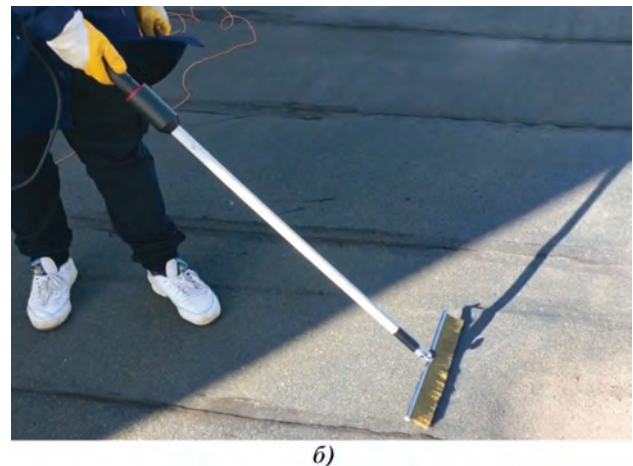
Рис. 2. Схематическое изображение процесса фиксации дефекта при электроискровом контроле (а) и процесс контроля сплошности гидроизоляционного покрытия с использованием электроискрового дефектоскопа (б)
