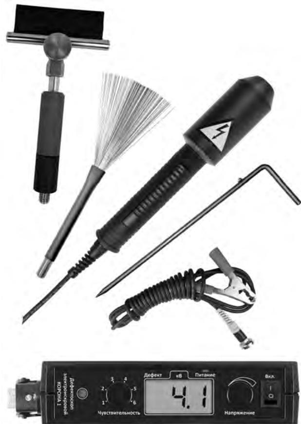
Рис. 3. Электроискровой дефектоскоп серии «Корона» с базовым комплектом аксессуаров
