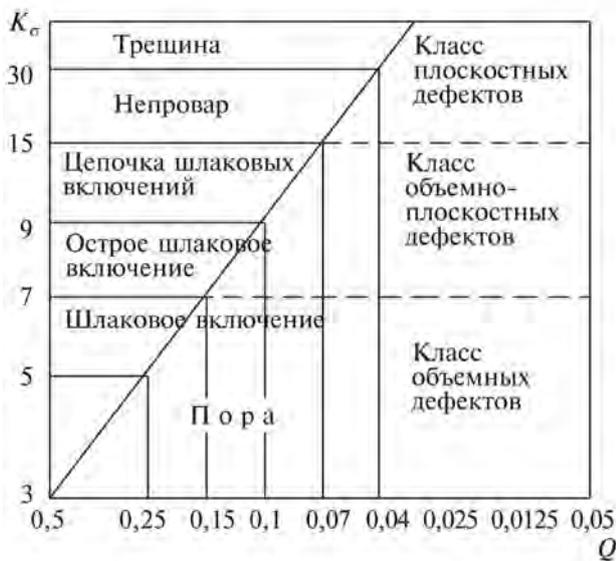
Рис. 2. Трехуровневая система классификации эллиптических отражателей, связывающая коэффициент концентрации напряжений  $K_{\sigma}$  с коэффициентом формы отражателей  $Q$
