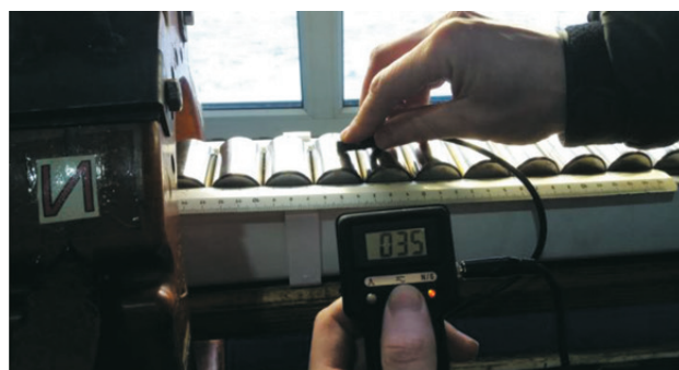
Рис. 10. Схема измерения тангенциальной составляющей H_t для цепочки роликов по ширине
