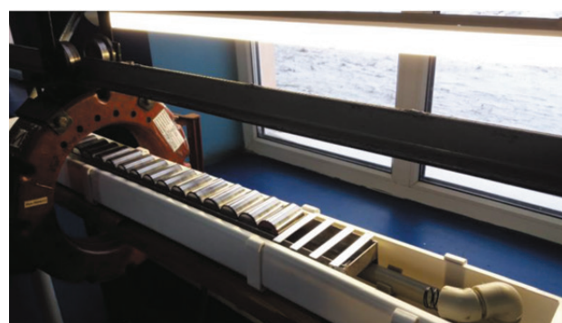
Рис. 8. Схема измерения тангенциальной составляющей H_t для цепочки роликов по длине
