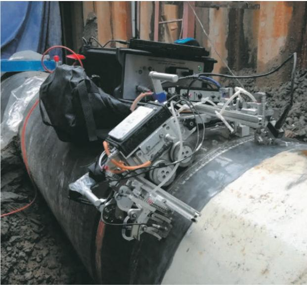
АУЗК сварного соединения диаметром 720 мм системой «АВГУР-ТФ»
