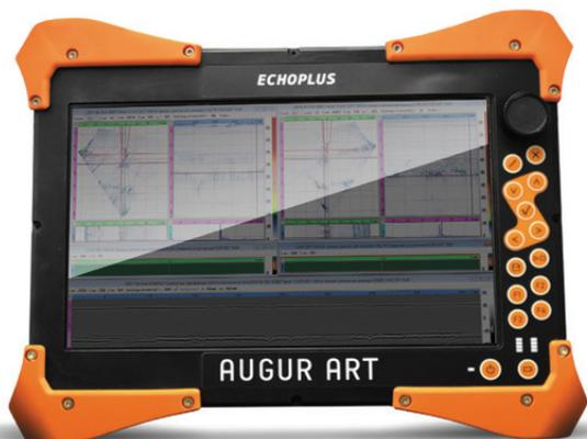
Ультразвуковой дефектоскоп «АВГУР-АРТ»
