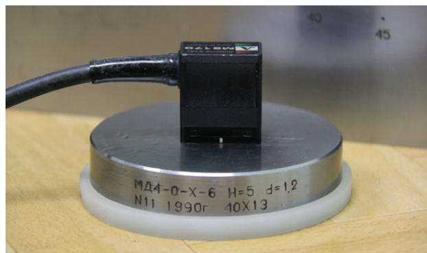
Рис. 2. Образец с плоскдонным сверлением на глубине 5 мм,  $d=1,2$  мм
