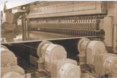
Испытания тяжелых пластин струями свободной воды
