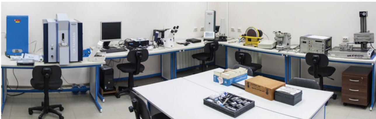
Оборудование лаборатории разрушающих испытаний ООО «КЦСК» для определения химического состава металлов и сплавов, структуры, микротвердости
