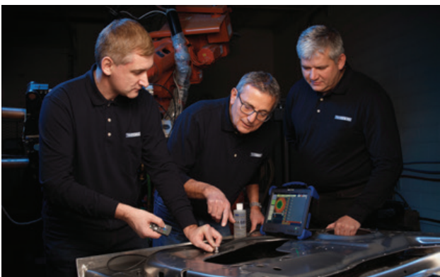
Контроль точечной сварки специализированным ультразвуковым дефектоскопом
