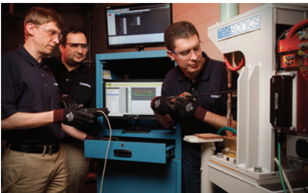
Контроль точечной сварки с помощью приборов компании «Тессоникс» с применением алгоритмов искусственного интеллекта
