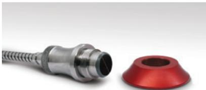
Высокотемпературный преобразователь П112-У5Е производства ООО «Константа УЗК» со съемным теплоотводящим кольцом (справа)
