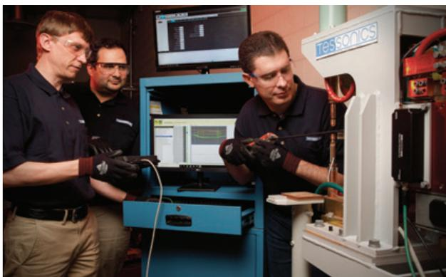
Контроль точечной сварки с помощью приборов компании «Тессоникс» с применением алгоритмов искусственного интеллекта
