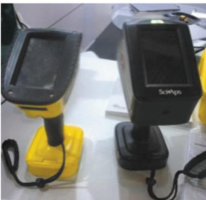
Портативный анализатор металлов и сплавов SciAps
