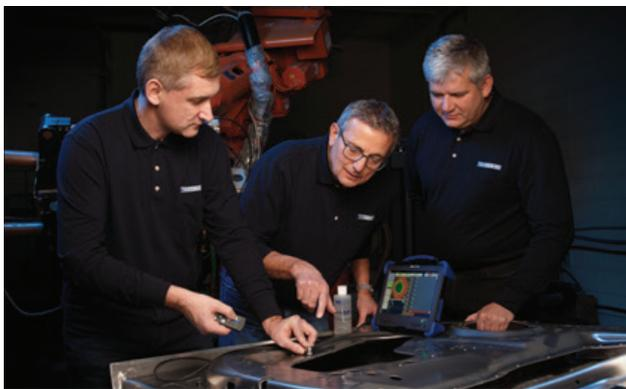
Контроль точечной сварки специализированным ультразвуковым дефектоскопом
