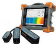
**Дефектоскоп EDDYFI LYFT** предназначен для картографирования коррозии объектов из углеродистой стали без снятия изоляции. LYFT позволяет проводить оценку состояния металлических объектов толщиной до 32 мм и под слоем изоляции до 152 мм.
