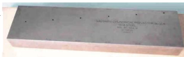
При выборе калибровочного блока требуется учесть два основных параметра: чувствительность калибровки и воспроизводимость результатов контроля:
