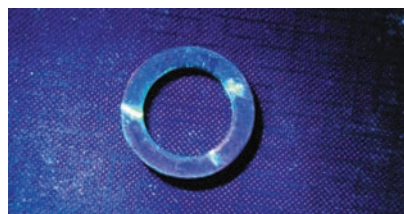
Шайба. Сквозные радиальные трещины
