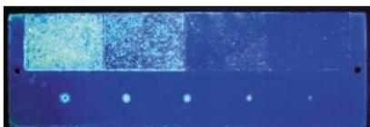
*Тест-панель PSM-5. Звездообразные трещины*
