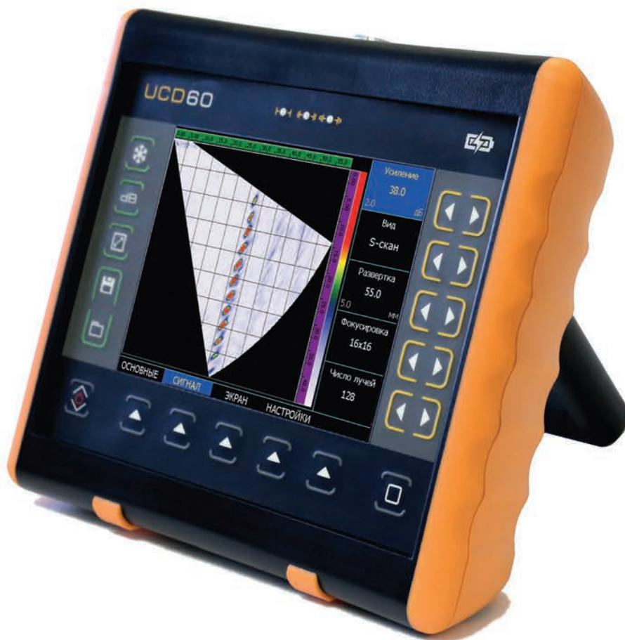
Новый ультразвуковой дефектоскоп УСД-60 ФР сочетает в себе возможности классических фазированных решеток с достижениями технологии цифровой фокусировки сигнала. Позволяя реконструировать полноэкранное изображение (640x480 точек) с 16-ти элементных датчиков ФР без потери производительности, этот легкий (1,4 кг) современный дефектоскоп является вершиной линейки высококачественных и надежных ультразвуковых дефектоскопов компании КРОПУС.
