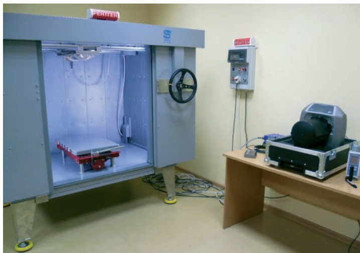
Установка цифровой радиографии в составе: – рентгеновский аппарат 0,3 СБК 150 С – разборная кабина радиационной защиты КРЗ-150 (1500×1000×1200) – механический манипулятор – цифровой сканер фосфорных пластин
