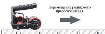
Рис. 8. Схема контроля ультразвуковой системой RS2WP
