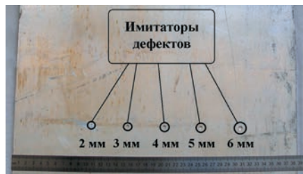
Рис. 7. Образец-лист с имитаторами дефектов
