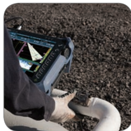
Контроль сварных швов труб малого диаметра
