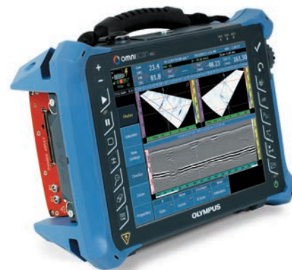
УЗК-дефектоскоп OmniScan 32:128 с 32 активными каналами для фазированной решетки
