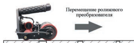
Рис. 11. Схема контроля ультразвуковой системой RS2WP образца № 3
