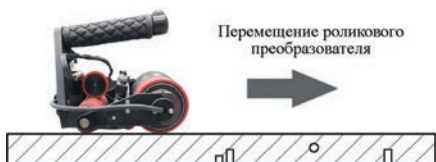
Рис. 5. Схема контроля ультразвуковой системой RS 2 WP
