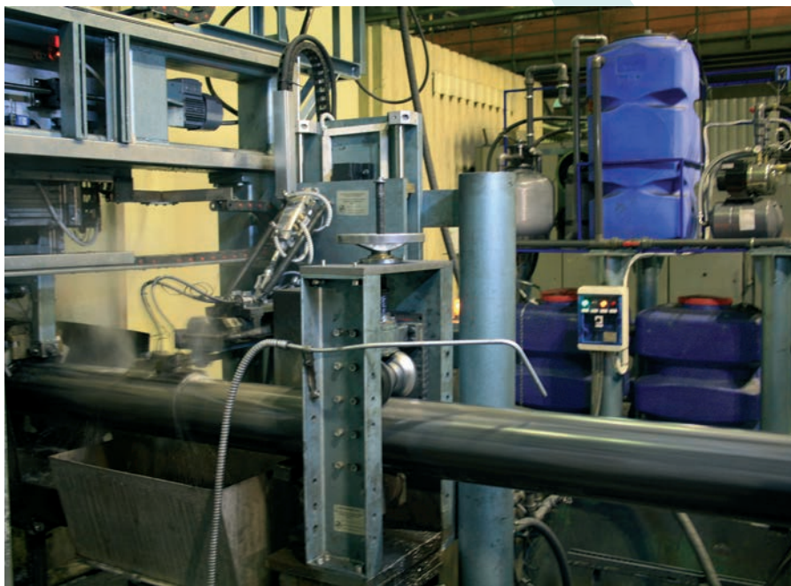
Установка автоматизированного ультразвукового контроля продольных сварных швов труб ПШ-11ЕРW
