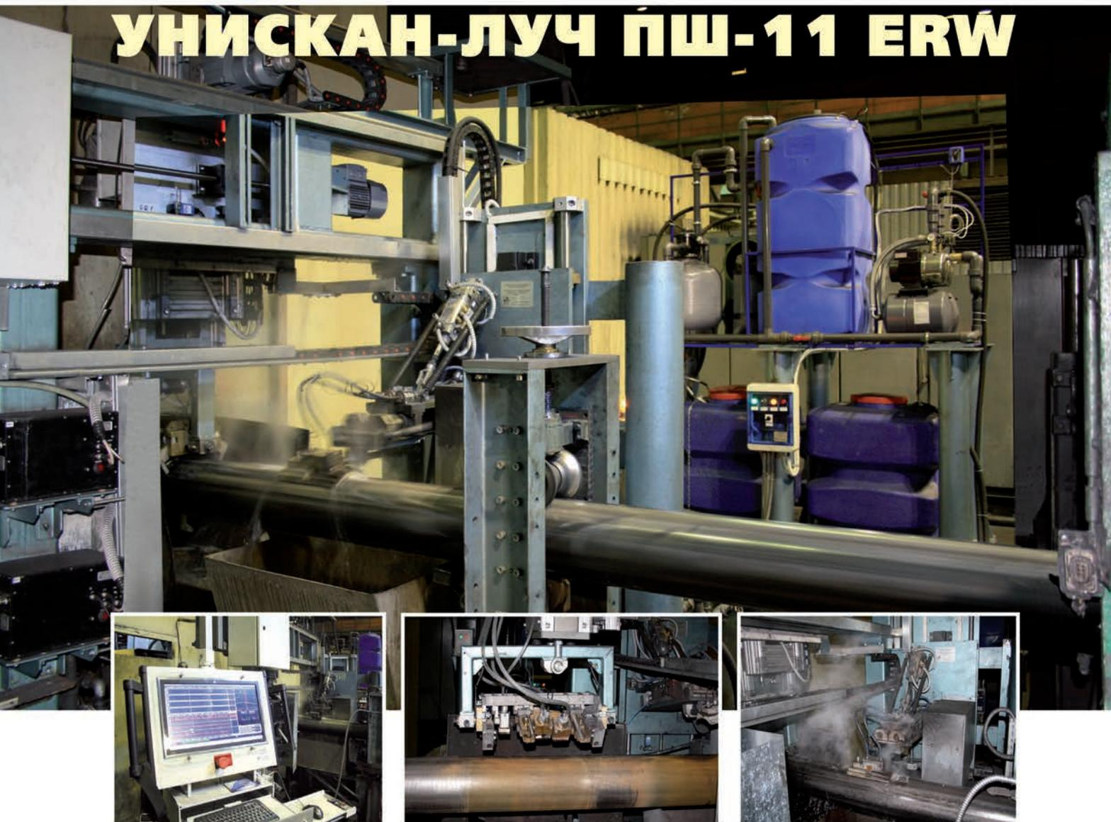
Автоматизированный ультразвуковой контроль продольного сварного шва и околошовной зоны труб на наличие внутренних дефектов типа продольно-ориентированных трещин в зоне 20 мм от линии сплавления. Измерение профиля линии сплавления.
