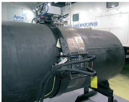
проводить измерение геометрических параметров обнаруженных дефектов.
