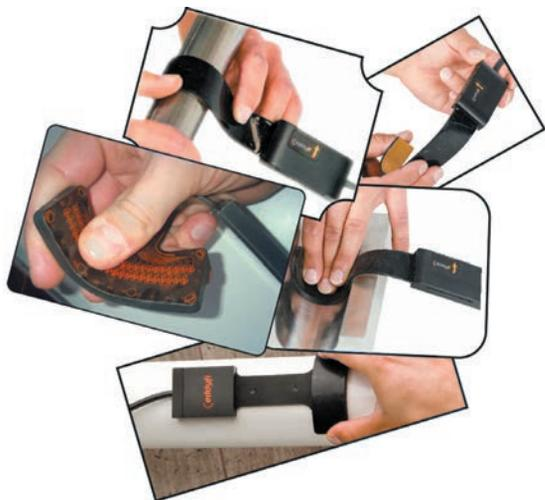
Рис. 8. Гибкие преобразователи для контроля криволинейных поверхностей
