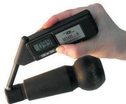
Рис. 2. Проведение измерения с помощью устройства ИМП-6
