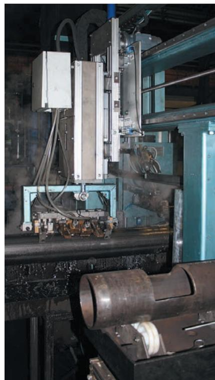
вой (либо магнитный) приемочный контроль тела трубы, магнитопорошковый контроль концов труб.
