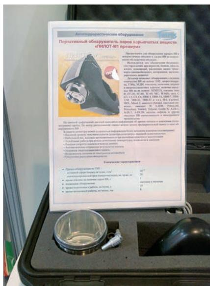
Это спектроанализатор ВВ на принципе измерения ионной подвижности. Для ионизации испаряемых веществ после пробоотбора используется коронный разряд. Система управления и экранизации процесса позволяет наглядно
