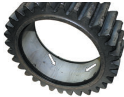
Рис. 1. Шлифовочные трещины на внутренней поверхности шестерни привода электровоза выявлены магнитопорошковым методом при циркулярном намагничивании пропусканием тока по стержню, вставленному в отверстие шестерни
