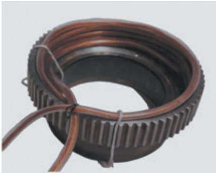
Рис. 7. Намагничивание внутренней поверхности шестерни наружным магнитным полем обмотки гибким кабелем
