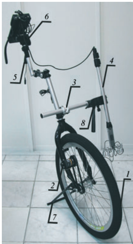
Рис. 1. Внешний вид сканирующего устройства: 1 – дорожное колесо; 2 – узел счета длины; 3 – узел крепления датчика Тип 11; 4 – датчик Тип 11; 5 – ручка; 6 – узел крепления измерительного прибора; 7 – складная опорная стойка; 8 – универсальная головка
