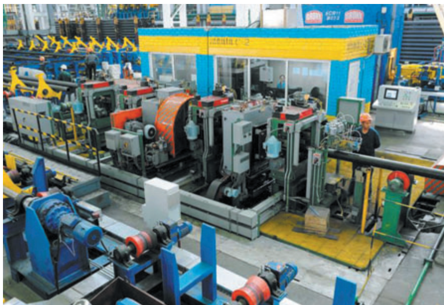
Рис. 4. Линия электромагнитного контроля качества
