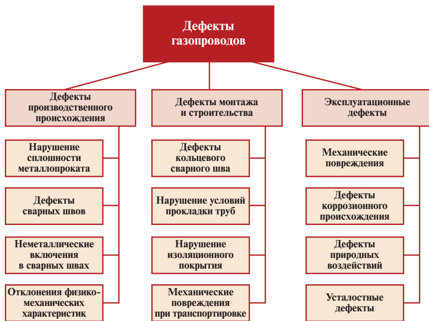
Рис. 2. Природа возникновения дефектов металла газопроводов
