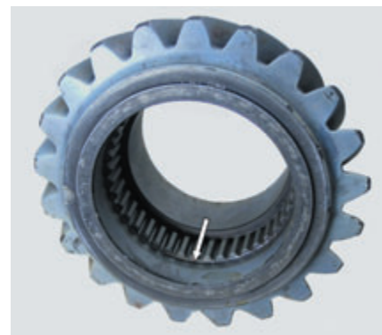
Рис. 5. Шестерня с усталостной трещиной (показана стрелкой), расположенной у основания шлицев, в плоскости, перпендикулярной оси детали, не обнаруженной магнитопорошковым методом при намагничивании в соленоиде способом, показанным на рис. 4. Трещина выявлена при намагничивании с помощью вставляемой обмотки из гибкого кабеля (см. рис. 7)
