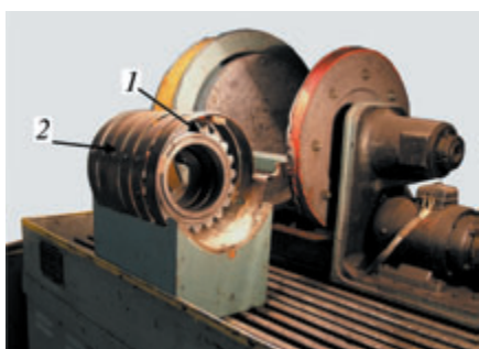
Рис. 4. Продольное намагничивание шестерни 1 в приставном соленоиде 2 стационарного магнитопорошкового дефектоскопа
