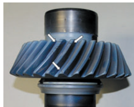
Рис. 2. Деформационные трещины на зубьях шестерни главного редуктора вертолета, возникшие в условиях эксплуатации, выявлены магнитопорошковым методом при циркулярном намагничивании пропусканием тока по детали
