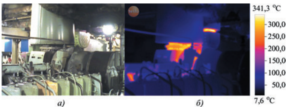
Рис. 6. Трубопровод отработавших газов на выходе из коллектора дизеля 6 VD26\20, максимальная температура 340 °С: а — фотоизображение; б — термограмма
