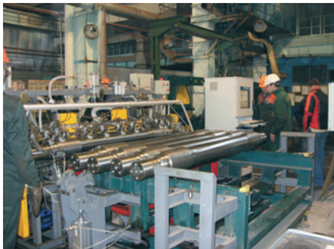
Рис. 1. Установка ультразвуковой и вихретоковой дефектоскопии железнодорожных осей «СНК «Ось-3»
