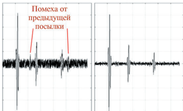
Рис. 1. Слева сигнал с добавлением белого шума и случайной помехой от предыдущий посылки, справа результат усреднения
